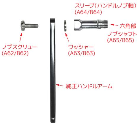
ハンドルノブ軸内の芯棒の端面(六角)を固定し、ノブスクリューをゆるめ外します。
