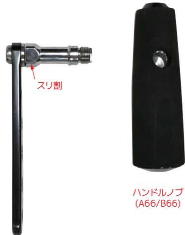
ハンドルノブ軸のスリ割部をモンキーレンチ等の工具で固定した状態でハンドルノブを反時計回りにゆるめ外します。
