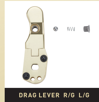
ドラグレバー 組み上げ後にテンションボールを入れられる外入れ式。右ハンドル用・左ハンドル用。
