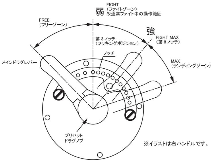
ドラグテンションの設定は、竿にリールをセットし糸を通した状態でハカリで測定して下さい。ファイトゾーン(5~8ノッチ)に必要なドラグ値に設定します。
